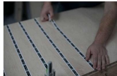
Wir finden, dass das Verlegen von ShaperTape in annähernd parallelen Linien am einfachsten ist, aber es besteht kein Grund, darauf Wert zu legen, da die Streifen nicht genau parallel oder genau gleichmäßig lang sein müssen. Die Ausrichtung des Bandes in Bezug auf Ihr Werkstück (parallel/senkrecht/diagonal) ist unkritisch und sollte an Ihr Projekt angepasst werden. Es sollte jedoch kein Klebeband überlappen.
